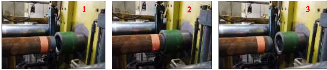
Gambar 10: Proses swaging head bergerak maju dan mendeformasi face pipa
