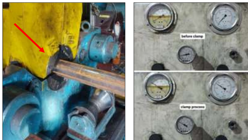
Gambar 9: Posisi pipa sudah dijepit oleh clamp dan indikator tekanan clamp
