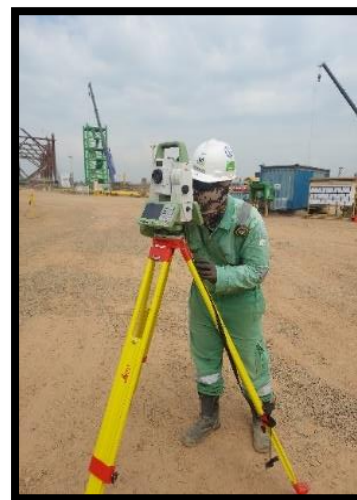
Gambar 4. Pengambilan data menggunakan alat total station
