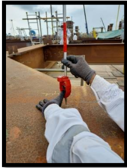
Gambar 5. Pengambilan point menggunakan alat Leica mini prisma
