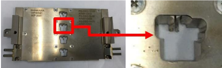
Gambar 3. Kerusakan pada window clamp
