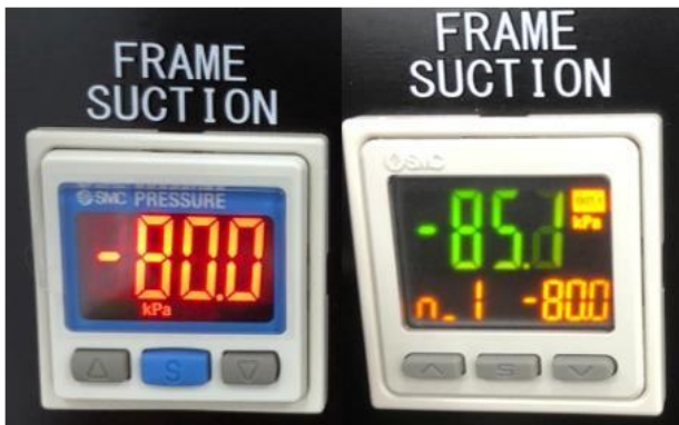
Gambar 11. Pembacaan nilai vakum pada air pressure display
