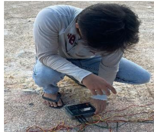
Gambar 5. Proses pengambilan nilai data menggunakan Earth Tester
