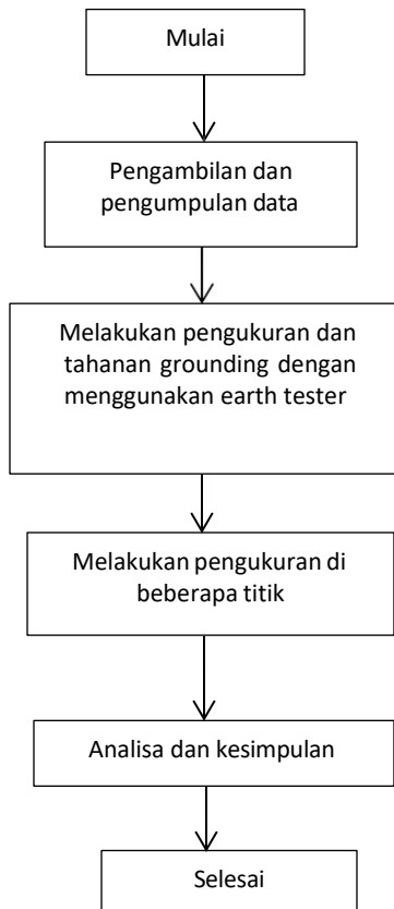
Gambar 1. Diagram Alir Sistem Tahanan Pentanahan
