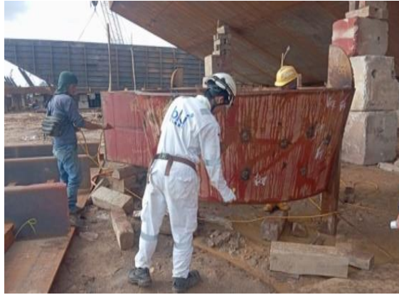
Gambar 4. 8 Proses Pemeriksaan ulang saat air pressure test bersama BKI
