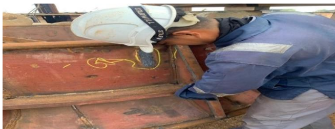
Gambar 3. 4 Pemeriksaan visual pada lasan di kort nozzle
