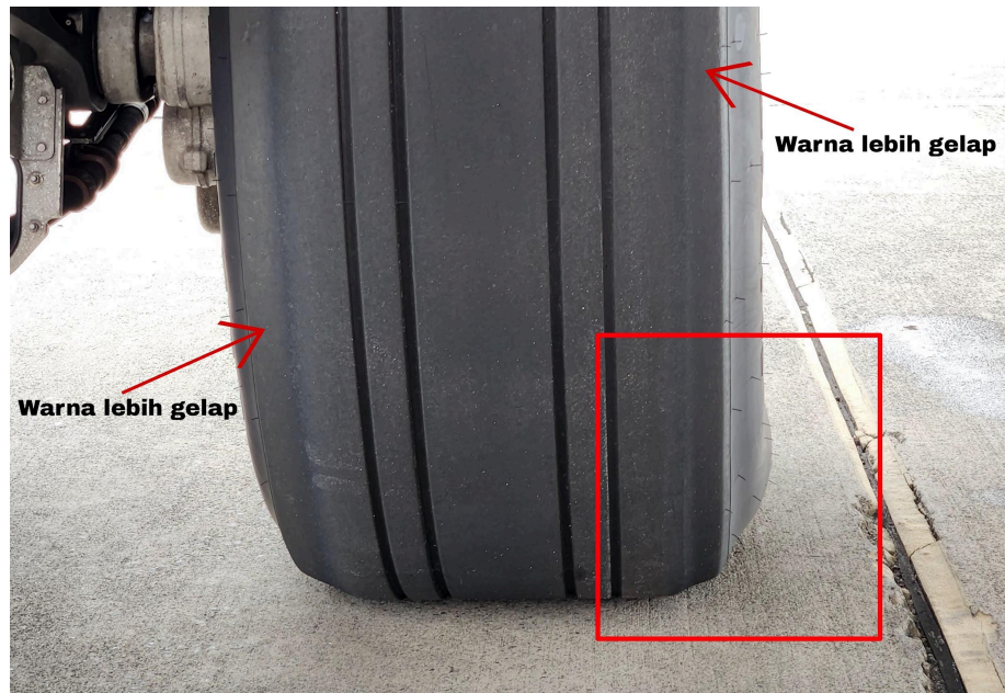
Gambar 6. Defleksi pada Main Wheel Tyre Sumber: Dokumentasi Pribadi
