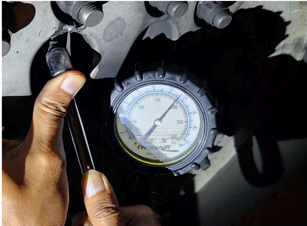
Gambar 12. Tyre Press M/W #3 PK-LHM (Sumber: Dokumentasi Pribadi)
