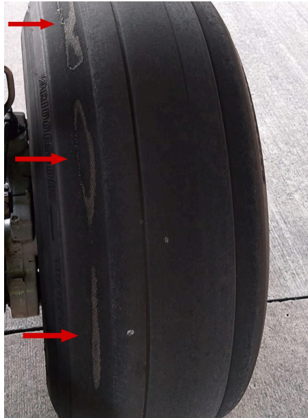
Gambar 2. Temuan Mainwheel Shoulder Wear pada Boeing 737-900ER (Sumber: Dokumentasi Pribadi)
