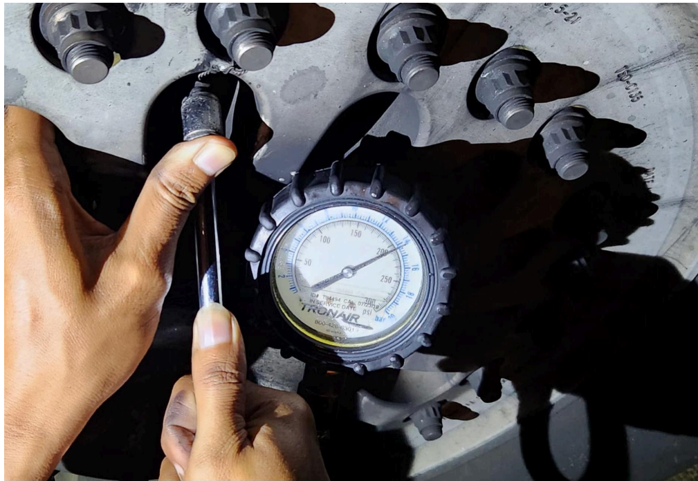
Gambar 10. Tyre Press Check M/W #3 PK-LFL (sumber: Dokumentasi Pribadi)
