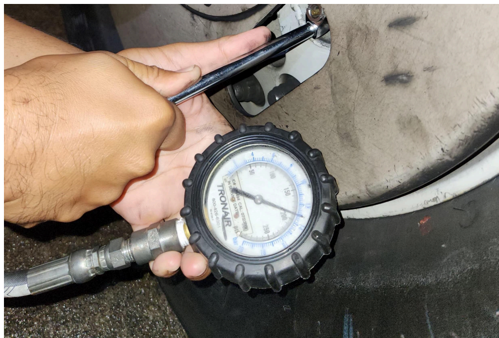
Gambar 11. Tyre Press M/W #2 PK-LGJ (Sumber: Dokumentasi Pribadi)
