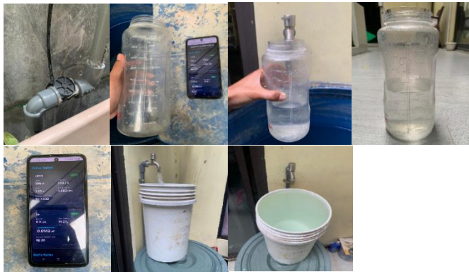
Gambar 16. Pengukuran akurasi sensor YF-S201.
