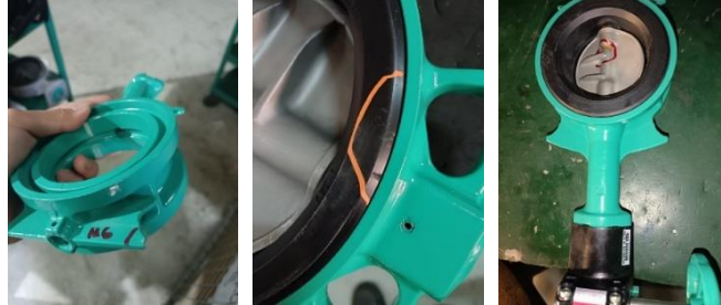
Gambar 3 : Bagian part yang rusak body , seating rubber , dan disc
