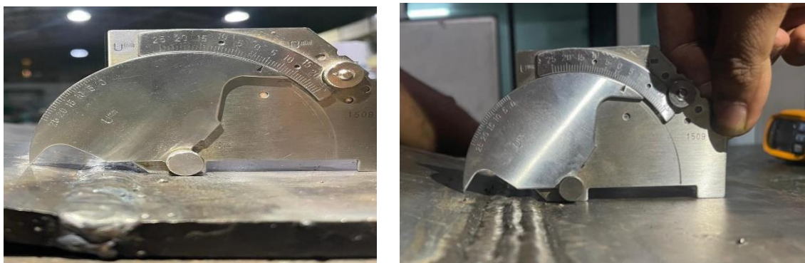
Gambar 3. Pengukuran kedua specimen menggunakan welding gauge
