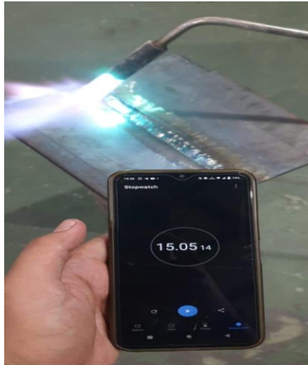
Gambar 7. Flame straightening pada specimen FCAW di suhu 400°C - 650°C selama 15 menit
