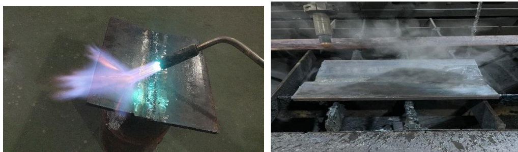
Gambar 4. Proses Flame straightening dan Pendinginan menggunakan air
