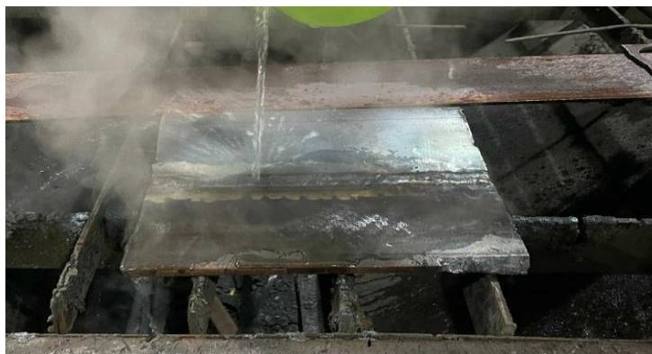
Gambar 9. Pendinginan specimen FCAW menggunakan air
