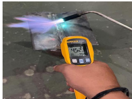
Gambar 6. Flame straightening pada specimen SMAW di suhu 400°C - 650°C
