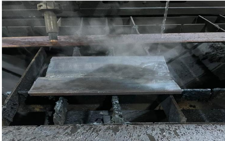
Gambar 10. Pendinginan specimen SMAW menggunakan air
