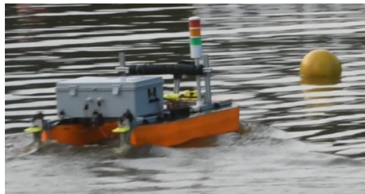
Gambar 4: kapal katamaran setelah proses fabrikasi
