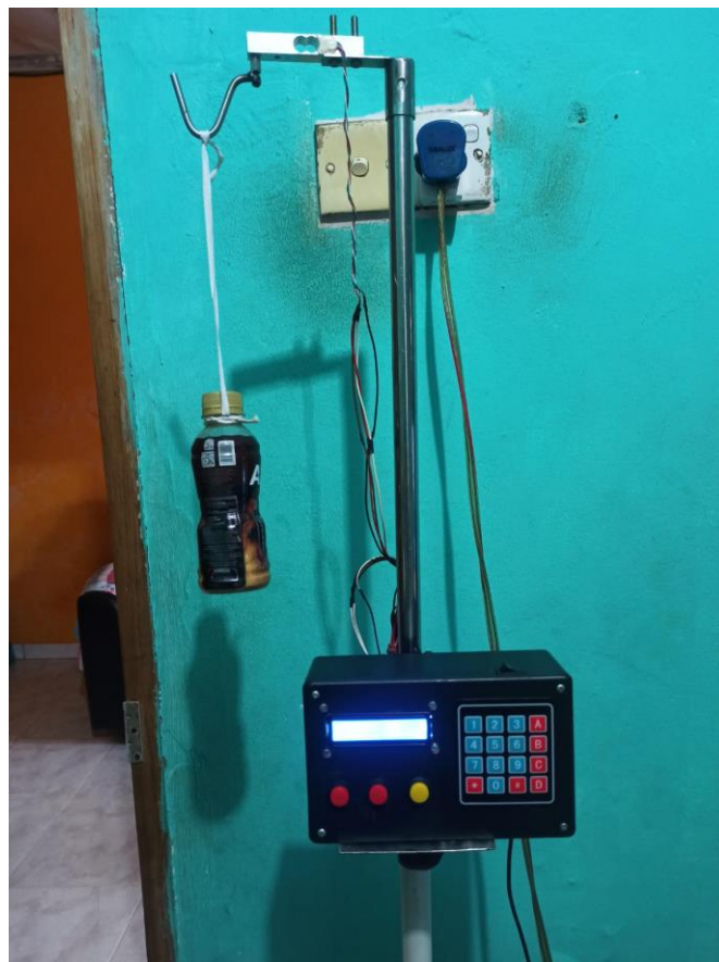
Gambar 2. Pengujian Kalibrasi Sensor loadcell
