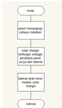
Gambar 10. Diagram sistem kerja pengisian daya
