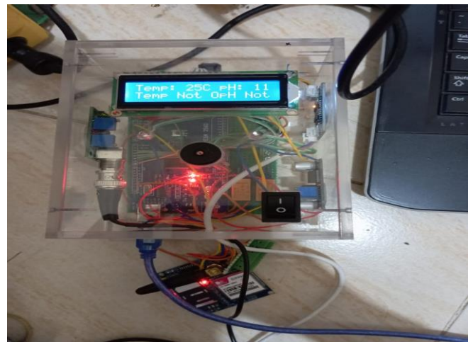
Gambar 14. Bangun Sistem Monitoring Kualitas Air Kolam Budidaya Ikan Air Tawar Menggunakan Sensor Dan Gsm Berbasis Arduino
