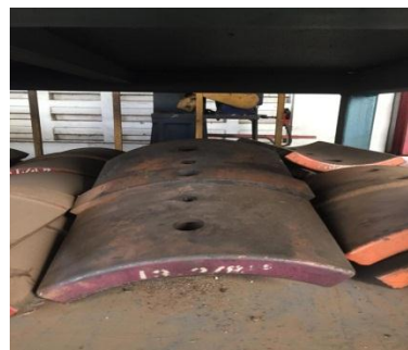
Gambar 5. Clamp untuk pipa 7\frac{5}{8} inch
