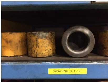
Gambar 2. Swaging untuk pipa 3\frac{1}{2} inch
