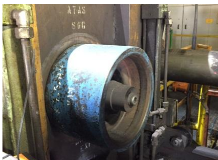
Gambar 4. Swaging untuk pipa 7\frac{5}{8} inch
