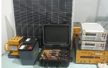
Gambar 19. Proses Kalibrasi Sensor PZEM-017
