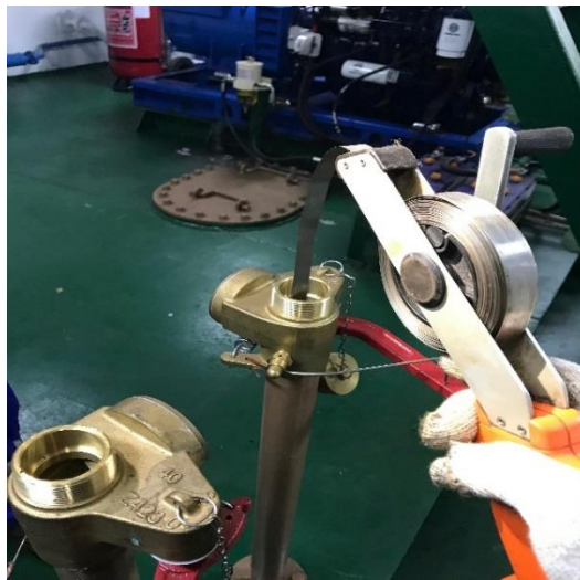
Gambar 3 Sounding tape pada kapal tugboat yang di ambil dari lapangan
