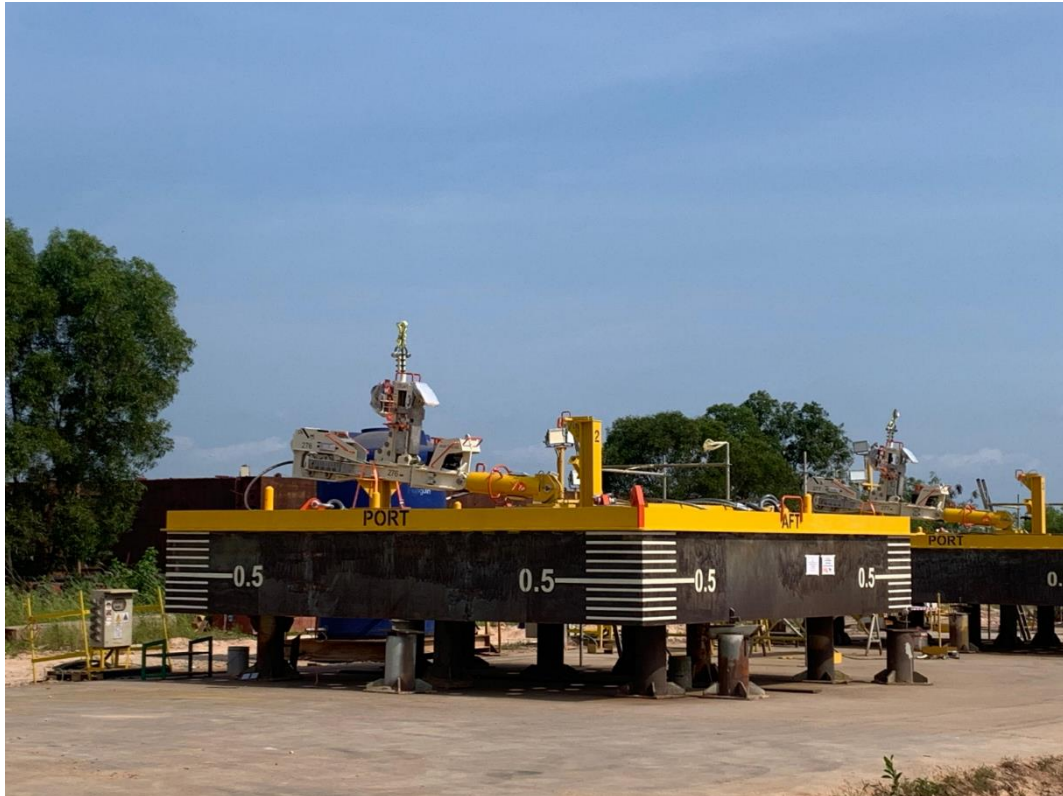
Gambar 1. Struktur clump weight pada proyek subsea
