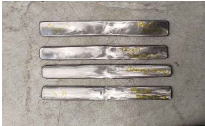
Gambar 7: Spesimen face bend dan root bend sebelum di uji
