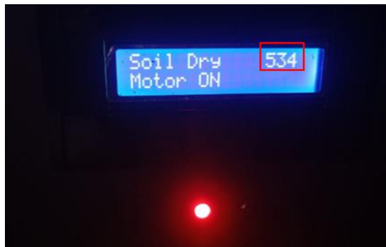
Gambar 11. Nilai ADC Saat Tanah Kering
