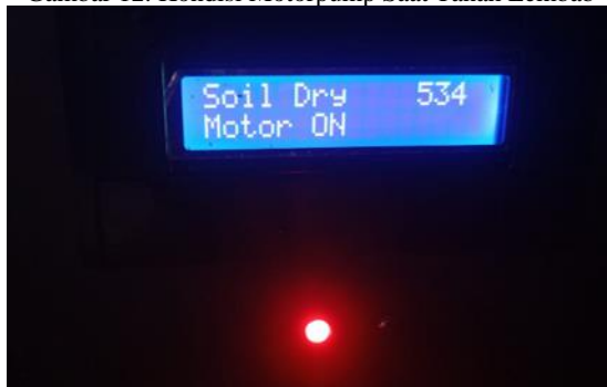
Gambar 13. Kondisi Motorpump Saat Tanah Kering
