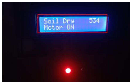
Gambar 15. Tampilan LCD Saat Tanah Kering
