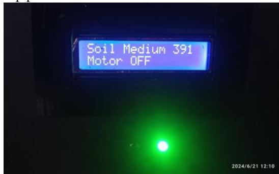
Gambar 12. Kondisi Motorpump Saat Tanah Lembab
