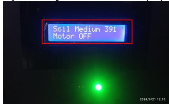
Gambar 14. Tampilan LCD Saat Tanah Lembab
