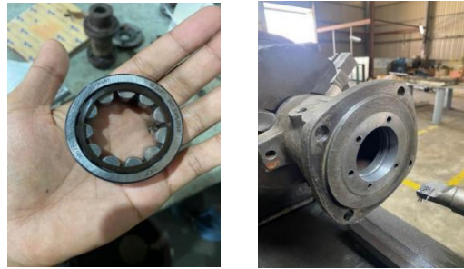
Gambar 3.6. Bearing dan Rumah bearing pompa sentrifugal
