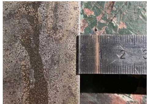
Gambar 13: Hasil makro HAZ spesimen 1 memiliki lebar 1mm
