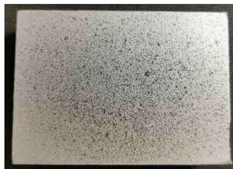
Gambar 14: Hasil makro HAZ spesimen 2 memiliki lebar 1mm
