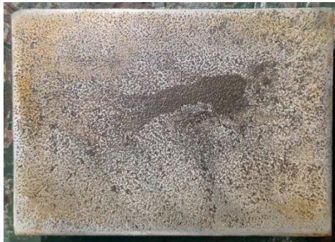
Gambar 13: Hasil makro HAZ spesimen 1 memiliki lebar 1mm
