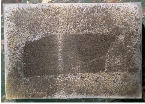
Gambar 15: Hasil makro HAZ spesimen 3 memiliki lebar 1mm
