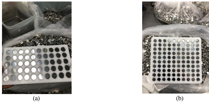
Gambar 1 : (a) Jig dan Komponen Cap dual , (b) Jig dan Komponen Case
