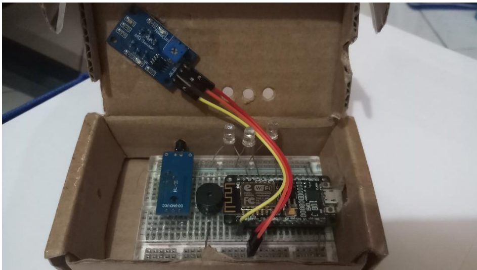
Gambar 4.2. Perangkat Pendeteksi Kebocoran Gas (Dalam)
