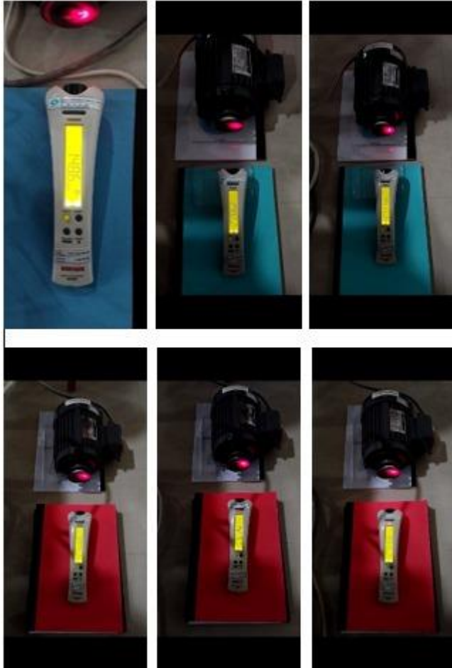
Gambar 15. Pengambilan data rpm Motor Dengan Tachometer
