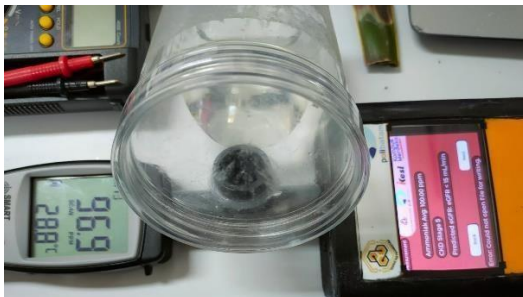
Gambar 18. Mengukur Konsentrasi Gas Ammonia
