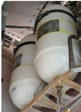
Gambar 2 : Brake Accumulator pada pesawat Airbus A330-300 [3]
