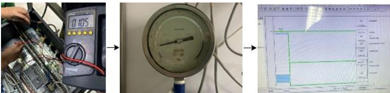
Gambar 8 Pengujian pengukuran nilai tegangan pada Pressure Transmitter
