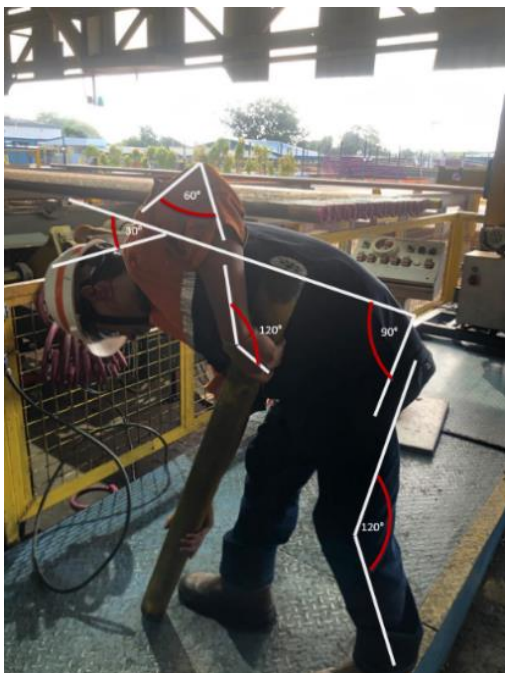
Gambar 2: Pengangkatan Drift Dari Bawah Ke Pipa
