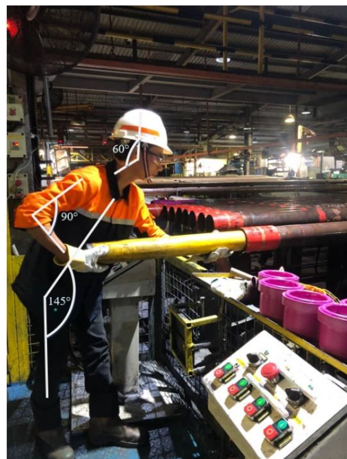
Gambar 3: Pemasukan Drift Ke Pipa
