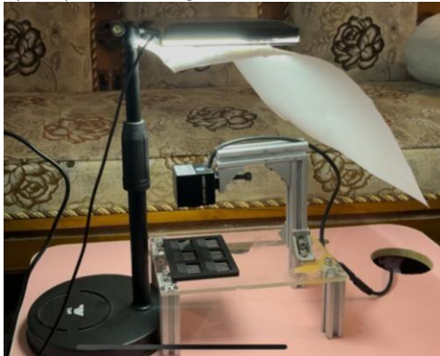
Gambar 5. Realisasi Konfigurasi Hardware akuisisi citra
