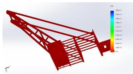
Gambar 12(b) Factor of safety pada A-frame
