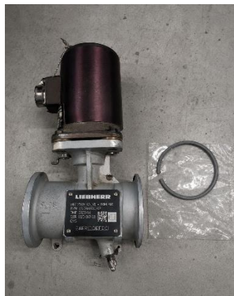
Gambar 5. Temuan visual kondisi TAV pada C Check 03
