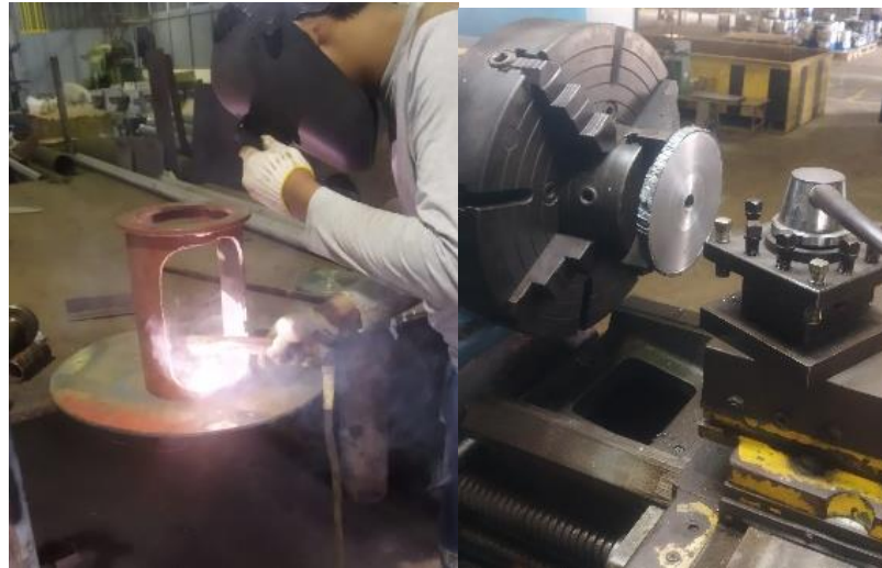
Gambar 9 : Proses Pembubutan dan Pengelasan untuk Pembuatan Base Support Bearing yang Akan di Assembly
