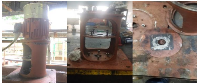
Gambar 4: Rekam Foto Agitator Mixer Sebelum Mengalami Redesain dan Fabrikasi
