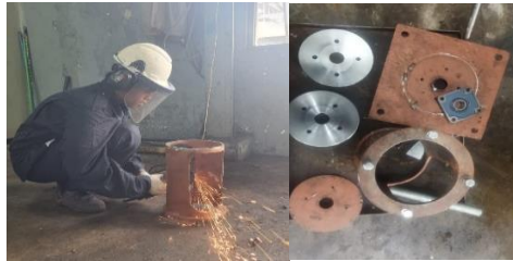
Gambar 7: Proses Pembongkaran Bagian-bagian yang Ada pada Base Support Bearing
