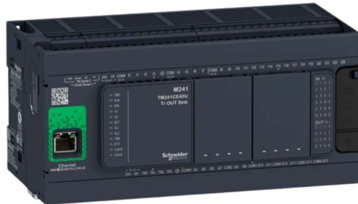
Gambar 2. PLC Schneider TM241CE40R
