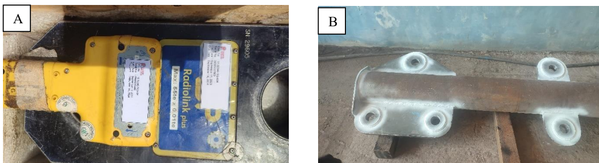
Gambar 7: a) Equipment yang terkalibrasi, b) Spreader bar setelah pengujian MPI
