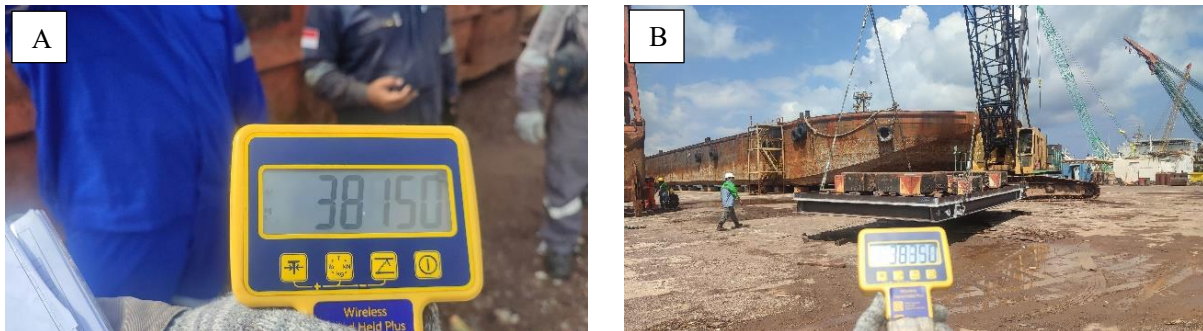
Gambar 8: a) Besar beban yang didapat selama pengangkatan, b) Gambar saat pengetesan dan perhitungan berat
