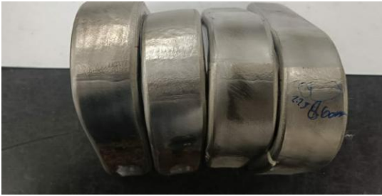
Gambar 20. Spesimen Pengujian Bend Non Preheat 1
