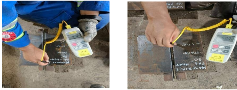
Gambar 9. Penggunaan thermocouple pada material preheat
