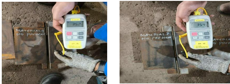
Gambar 8. Penggunaan thermocouple pada material non preheat
