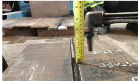
Gambar 6. Pengukuran Jarak alat dan base metal
