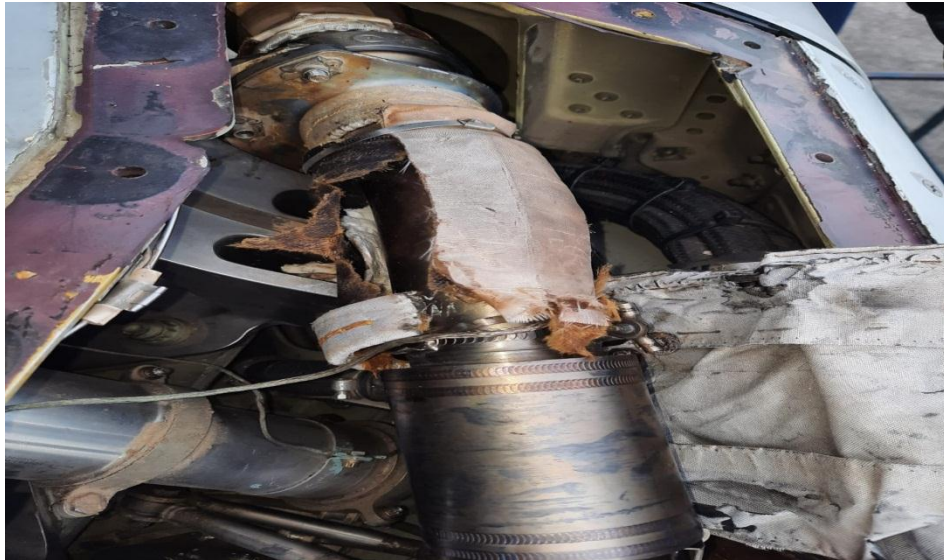
Gambar 6. Kebocoran seal pada bagian wing .
