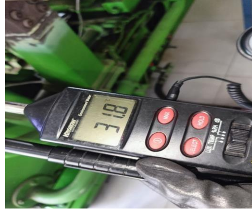
Gambar 4. Pengukuran Iklim Kerja
