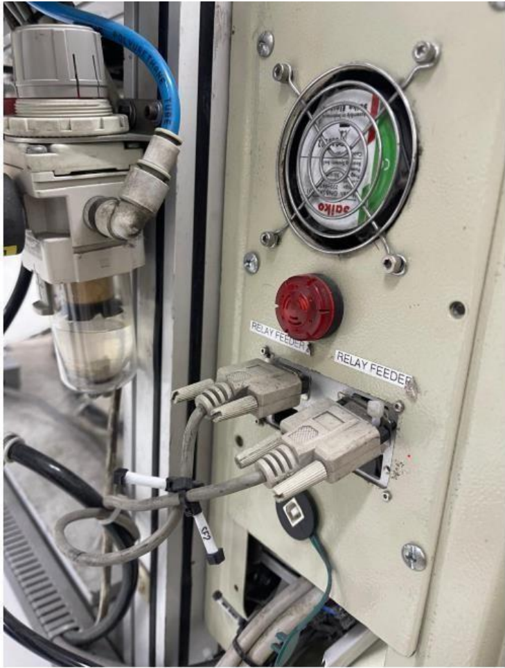
Gambar 67 Connector Komunikasi Feeder
