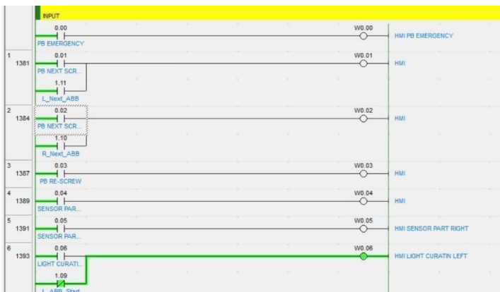
Gambar 32 Pemeriksaan Sinyal Input pada Software
