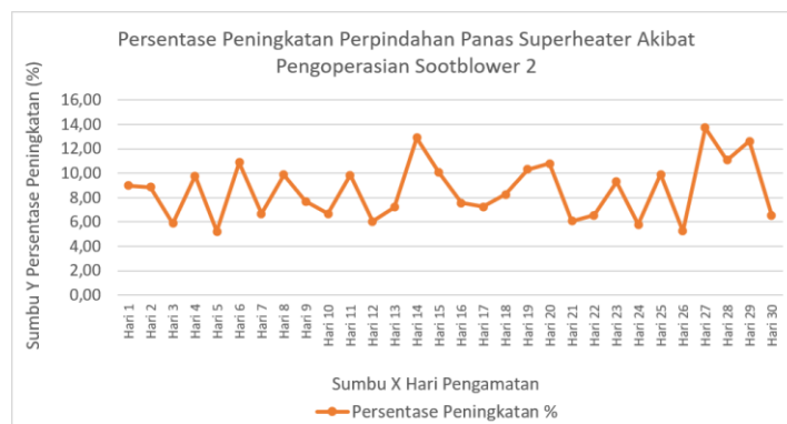
Gambar 6. Persentase peningkatan perpindahan panas superheater akibat pengoperasian sootblower ke-2
