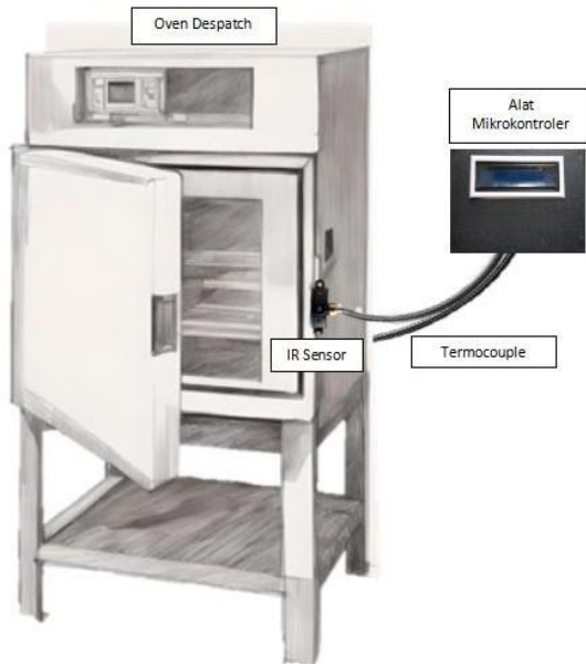
Gambar 13. Desain Sistem di Oven Despatch
