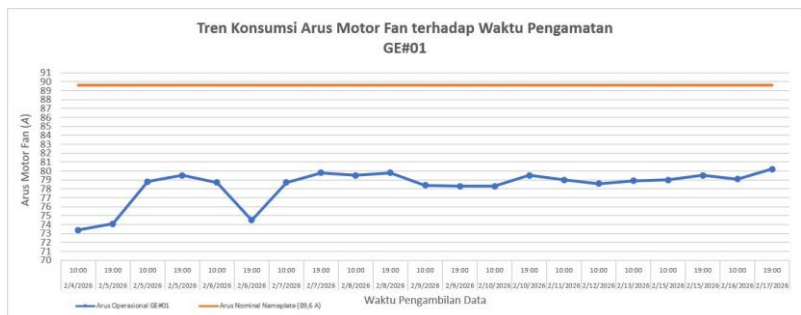
Gambar 18. Tren Konsumsi Arus Motor Fan terhadap Waktu Pengamatan pada Unit GE#01
