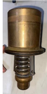
Gambar 6. Katup Termostatik Mekanis (AMOT Valve)
