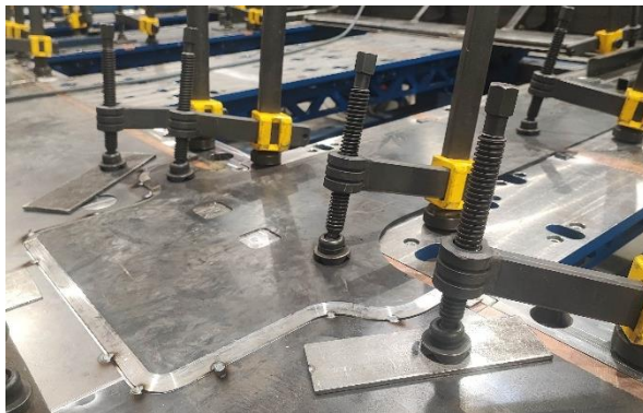
Gambar 3. Pemasangan Clamp pada perakitan dinding
