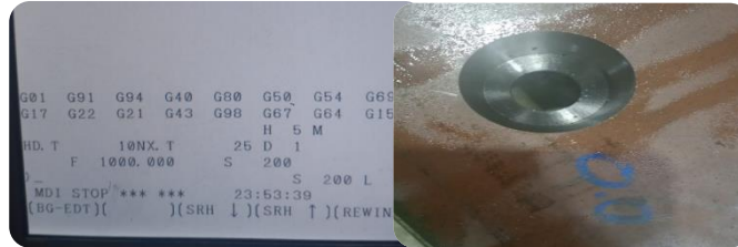
Gambar 3. Geram terbuang dengan efektif, permukaan lubang yang paling halus.
