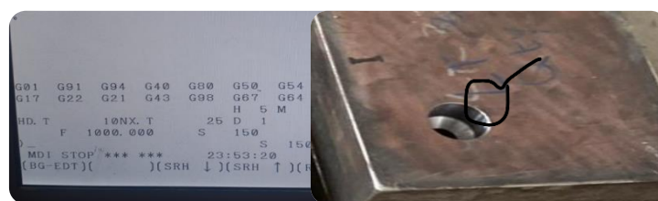
Gambar 2. U-Drill tidak dapat memotong secara efektif, permukaan yang sangat kasar.
