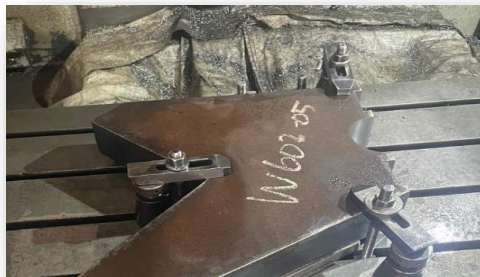
Gambar 7. Benda kerja dijepit dengan baik dan benar.
