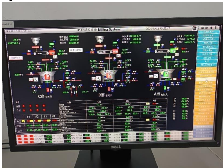
Gambar 15 Milling System pada DCS
