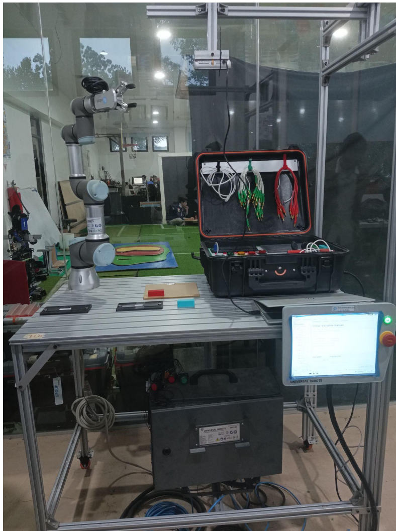
Gambar 2. Pengaturan hardware (PLC, Robot, Kamera, dan HMI)
