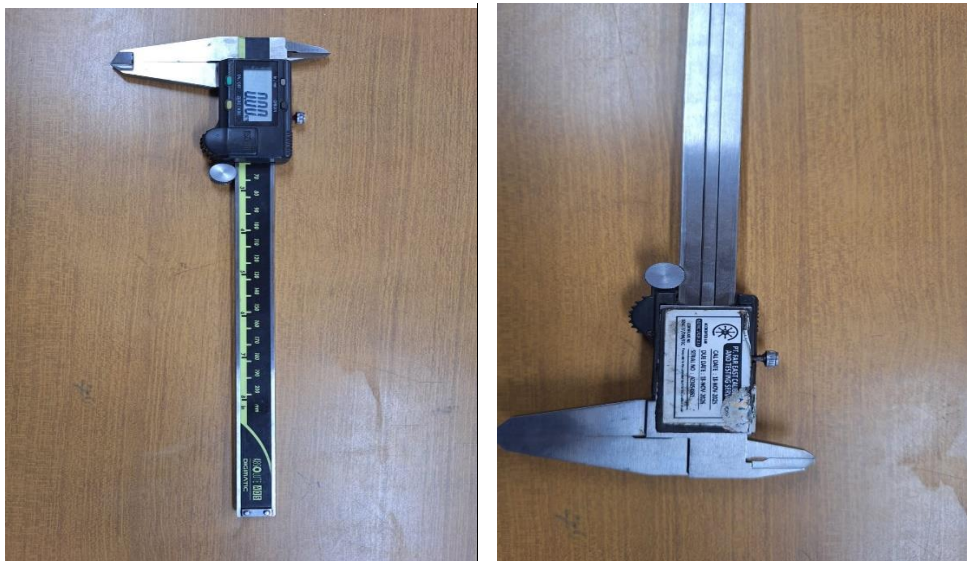
Gambar 1. Jangka sorong caliper ketelitian 0.01mm( sumber : foto pribadi )
