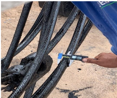
Gambar 5. Pengukuran wire rope ( sumber : foto pribadi )
