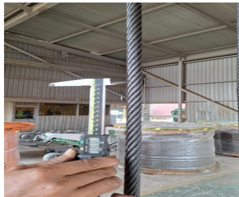
Gambar 5. Pengukuran wire rope ( sumber : foto pribadi )
