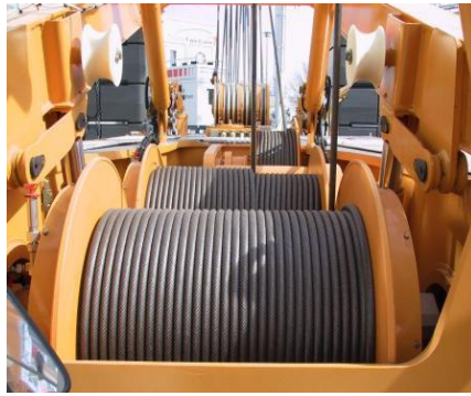
Gambar 3. Drum wire rope pada crane (Sumber : wikipedia )
