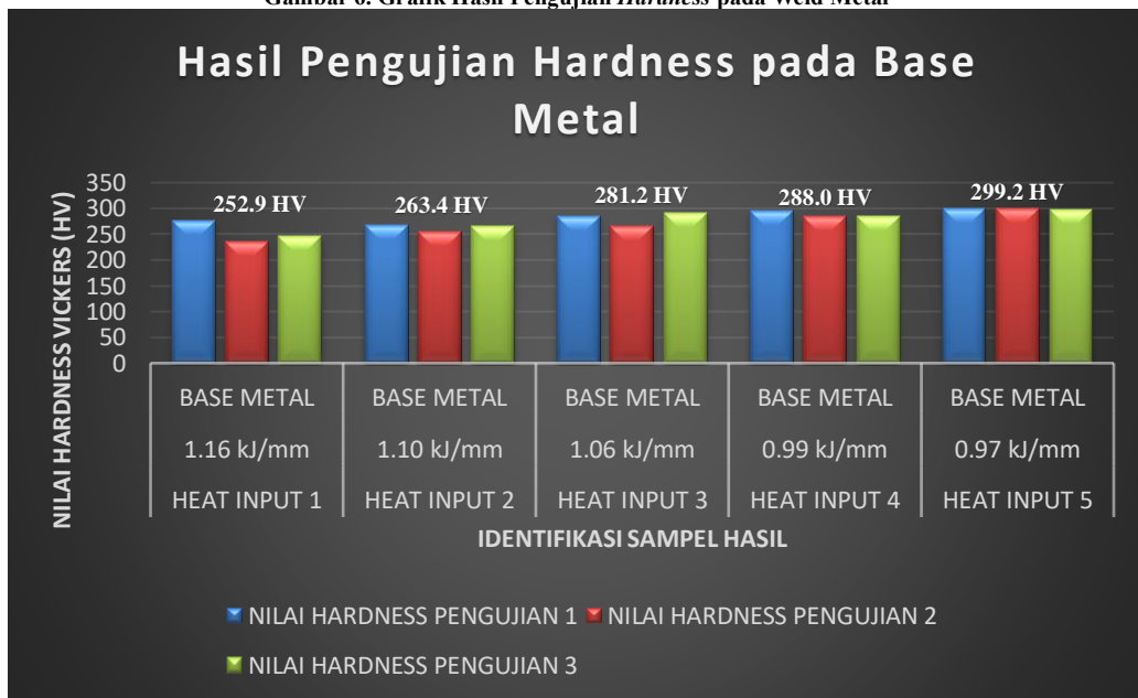
Gambar 7. Grafik Hasil Pengujian Hardness pada Base Metal
