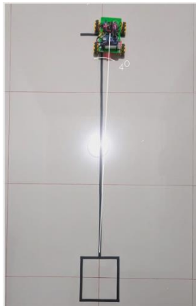
Gambar 4.10 Perpindahan robot dengan kontrol PID
