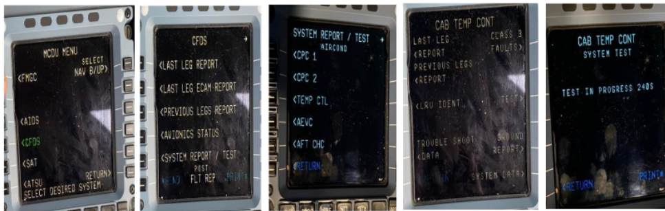
Gambar 9: operational test of the cockpit dan cabin control system pada mcd .
