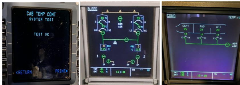
Gambar 10: Hasil test of the cockpit dan cabin control system pada mcd dan ecam .
