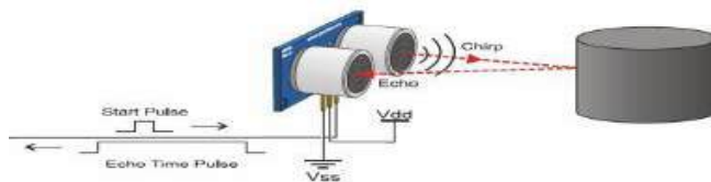
Gambar 3. Prinsip Kerja Ultrasonik
